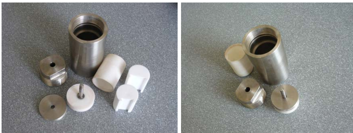
Рис. 1. Автоклав и его детали
