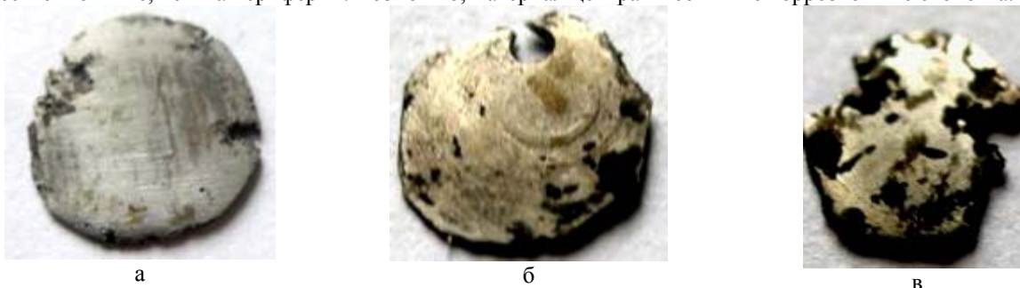
а – необлученный; б – отожженный при 550 0 С и облученный до флюенса 5 \times 10^{19} \text{ н/см}^2 ; в – отожженный при 550 0 С и облученный до флюенса 2 \cdot 10^{20} \text{ н/см}^2 .
