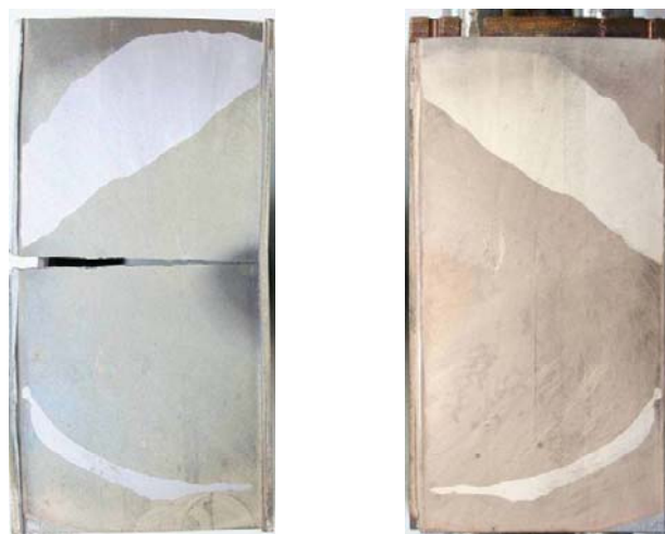
Рис. 5. Поверхности разрушения третьего макета первой стенки со стороны бериллия (слева) и со стороны бронзы (справа)
