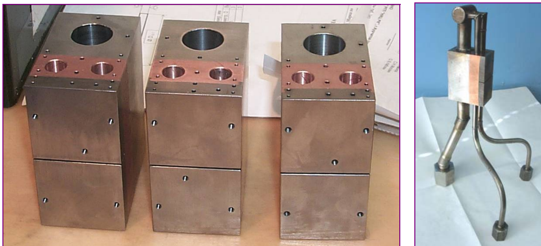
Рис. 1. Заготовки макетов первой стенки (слева) и один из макетов, подготовленный к термическим испытаниям (справа)
