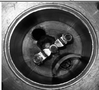
Рисунок 4 – Размещение исследуемого образца в вакуумной камере установки ВИКА
