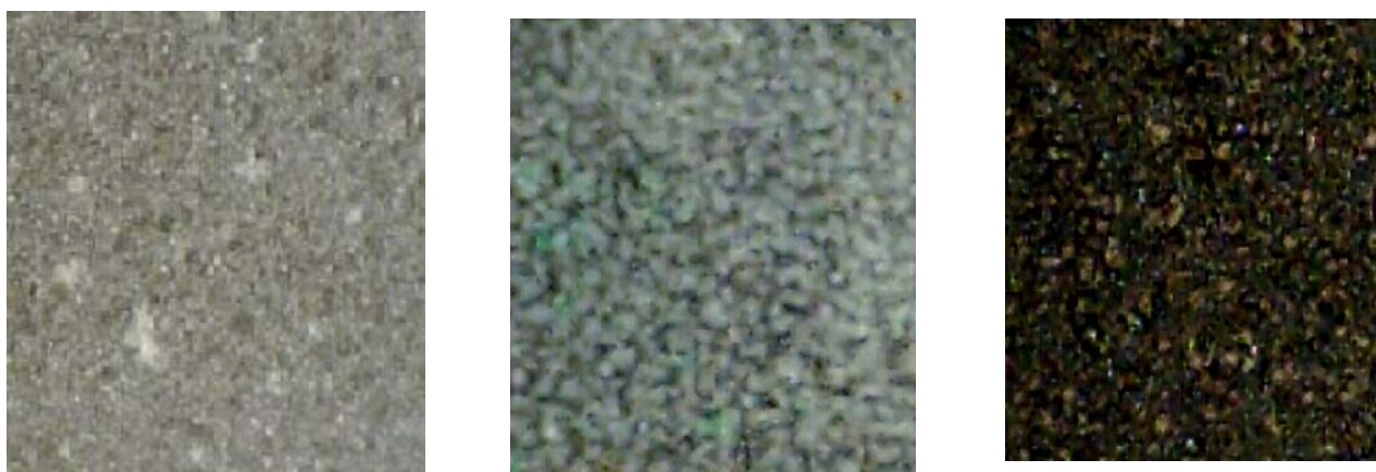
Рис. 5 - Оптические снимки поверхности церата бария: необлученной (a) и облученной ионами аргона (b); (c) – исходный образец
