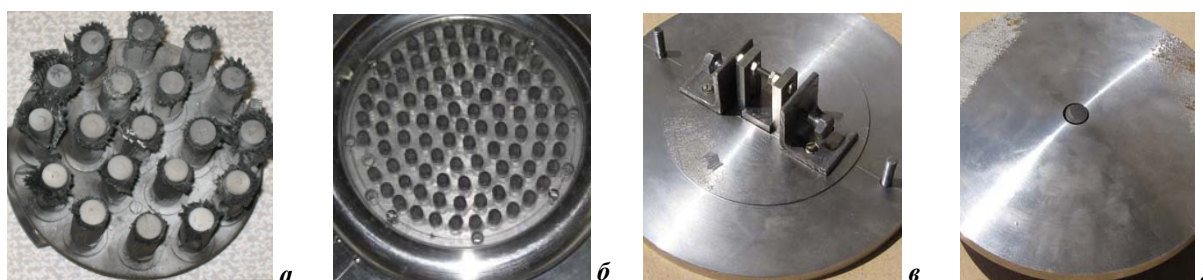
Рис. 1. Катоды с 19 (а) и 93 (б) элементами и детали нового анодного узла (в, г)
