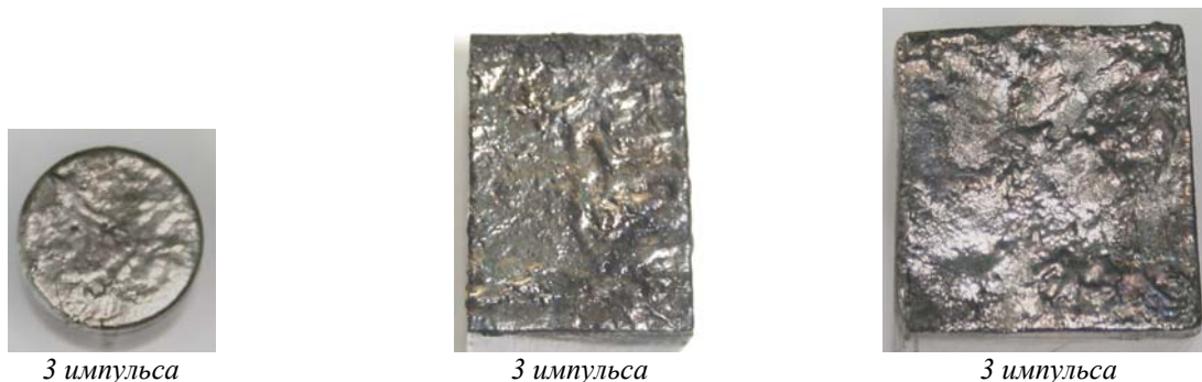
Рис. 4. Облученные Be-образцы (трубчатый катод, напряжение 520 кВ, межэлектродный зазор 35 мм, диаметр отверстия в пластине 25 мм)
