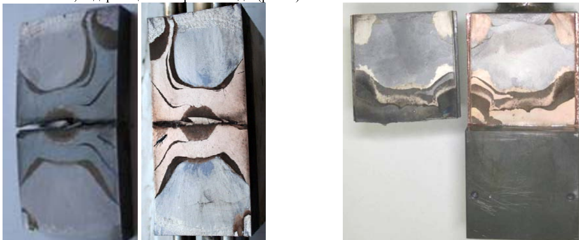
Рис. 2. Поверхности разрушения со стороны бериллия и со стороны бронзы у первого (слева) и у второго (справа) макетов первой стенки
