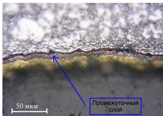
Рис. 3. Поперечное сечение вблизи границы бериллиевого слоя макета
