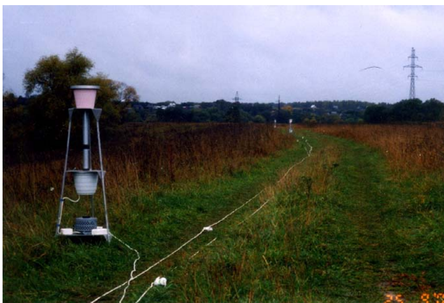
Рисунок 2. Иллюстрация возможности использования триады пробоотборников “Лотос” для фронтального отбора проб атмосферных радиоактивных аэрозолей вблизи источника их интенсивного поступления в атмосферу и их осаждения на подстилающей поверхности
