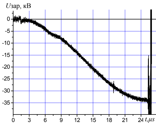
Рис. 4. Характерная осциллограмма U_{зар} емкостного накопителя C2
