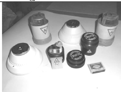
Учебный набор радиоактивных источников и пожарные извещатели, содержащие в себе радиоактивные источники плутония и америция
